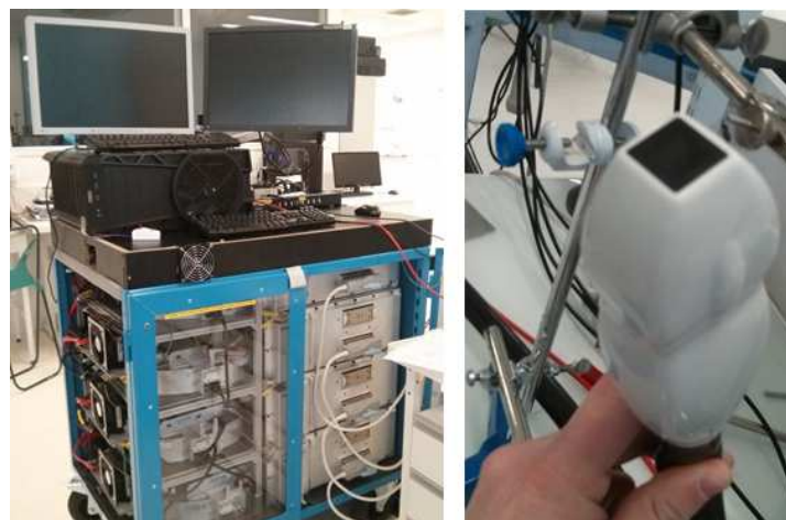
Figure 1. Plateforme d'imagerie ultrarapide (à gauche électronique 1024 voies, à droite sonde matricielle 1024 éléments)
